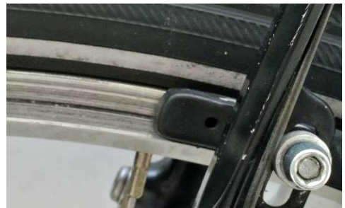
フロントリムのインジケーターの溝
