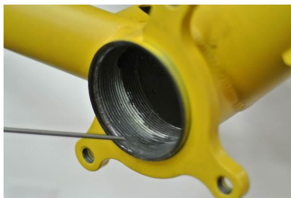
BBシェルのネジ部のパーツクリーナーによる洗浄
