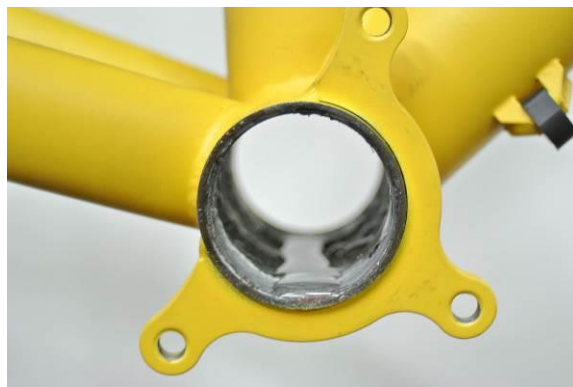
BBを取り外したときにBBシェル内部に浸入した水分が溢れ出る状態
