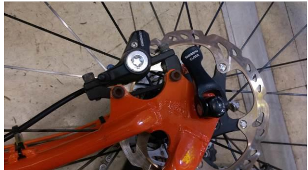
インターナショナルタイプのフレームに、ポストマウントアダプターによって取り付けられたリア用油圧式ディスクブレーキ
